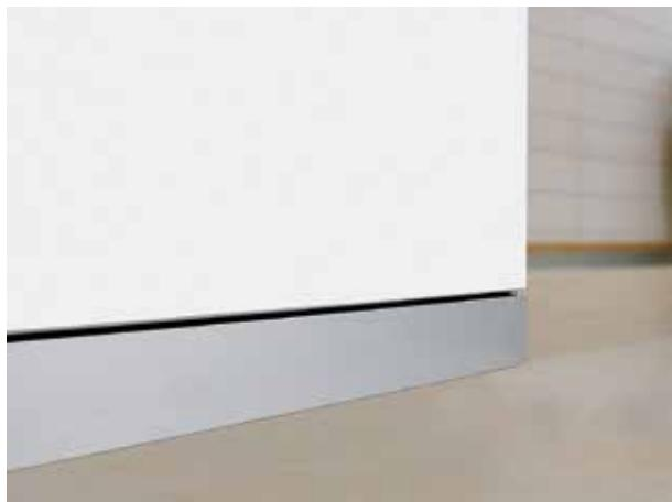
Das patentierte System besteht aus einem Stützprofil, das in die Struktur der Gipskartonwand bzw. in die verputzte Wand einzubauen ist. Anschließend wird ein Abschlussprofil aus Aluminium bzw. Holz eingefügt, was für eine schöne Optik sorgt. Das eingeklemmte Abschlussprofil gleicht Höhenunterschiede von bis zu 5 mm aus: das ist mit Hilfe eines "Ausgleichselements" möglich, das eine Abgrenzungslinie bildet und somit ein effektvolles Design entstehen lässt.
